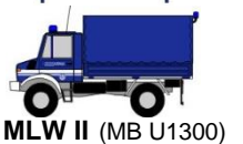
MLW II (MB U1300) (mit 1 x SEA 5 KVA + Pumpen 4.500 l/Min)
